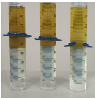
Рис. 1. Эмульсии (Масло-вода) после обработки ИМП при разных частотах (через сутки)
