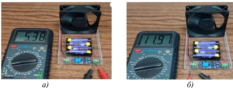
а) б) Рис. 3. Максимальное положение ручки усилителя: а) входное напряжение, б) выходное напряжение
